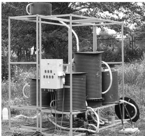
Рис. 1. Мобільна пілотна установка модульного типу для дослідження процесів очищення стічних вод (Корпорація «Енергоресурс-Інвест», м. Львів)
