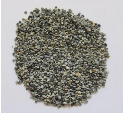
Рис. 3. Клиноптилоліт, модифікований іонами та високодисперсними частинками срібла
