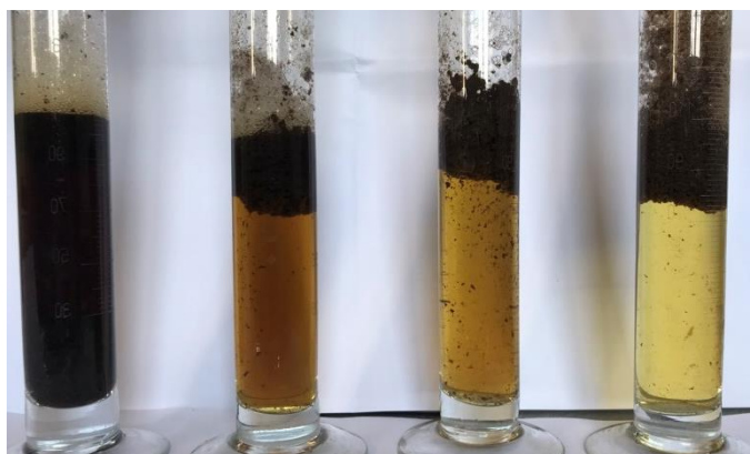
Рис. 2. Світлини фільтрату після додавання коагулянту та флокулянту: об'єм коагулянту, \text{см}^3 : а – 1; б – 1,5; в – 2,0; г – 2,5 (об'єм фільтрату – 100 \text{ см}^3 ; об'єм флокулянту – 2,5 \text{ см}^3 ).
