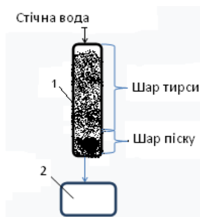
Рисунок 1 – Схема лабораторної установки очищення стічної води на комбінованому фільтрі
