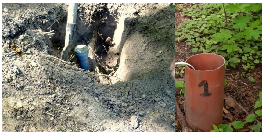
Рис. 3. Буріння спостережних свердловин та заміри рівнів ґрунтових вод та нафтопродуктів.
